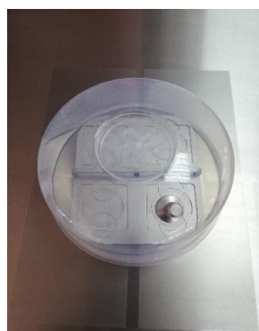
Abbildung 11.8 Gashaube über der Gasdüse
